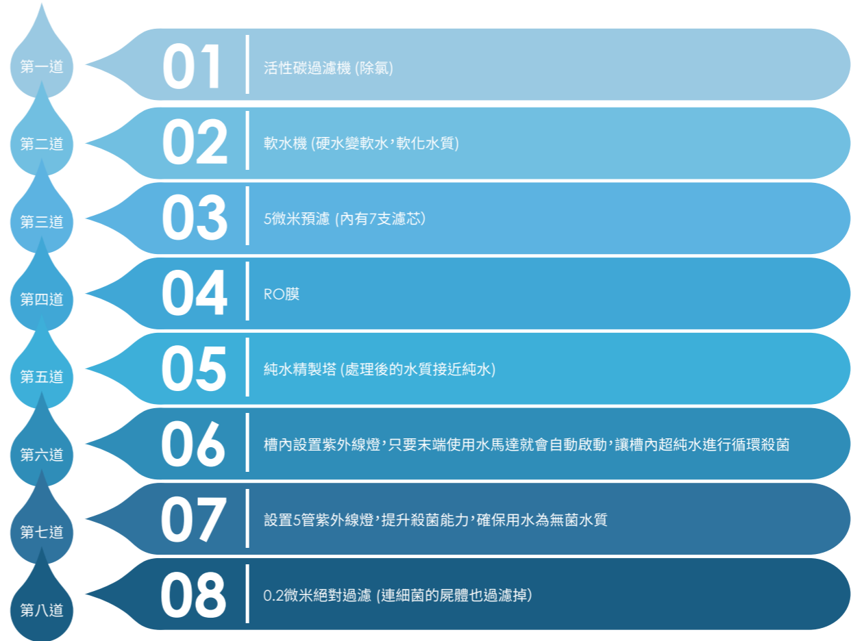
● 圖 2-14 八道程序製成超純水
