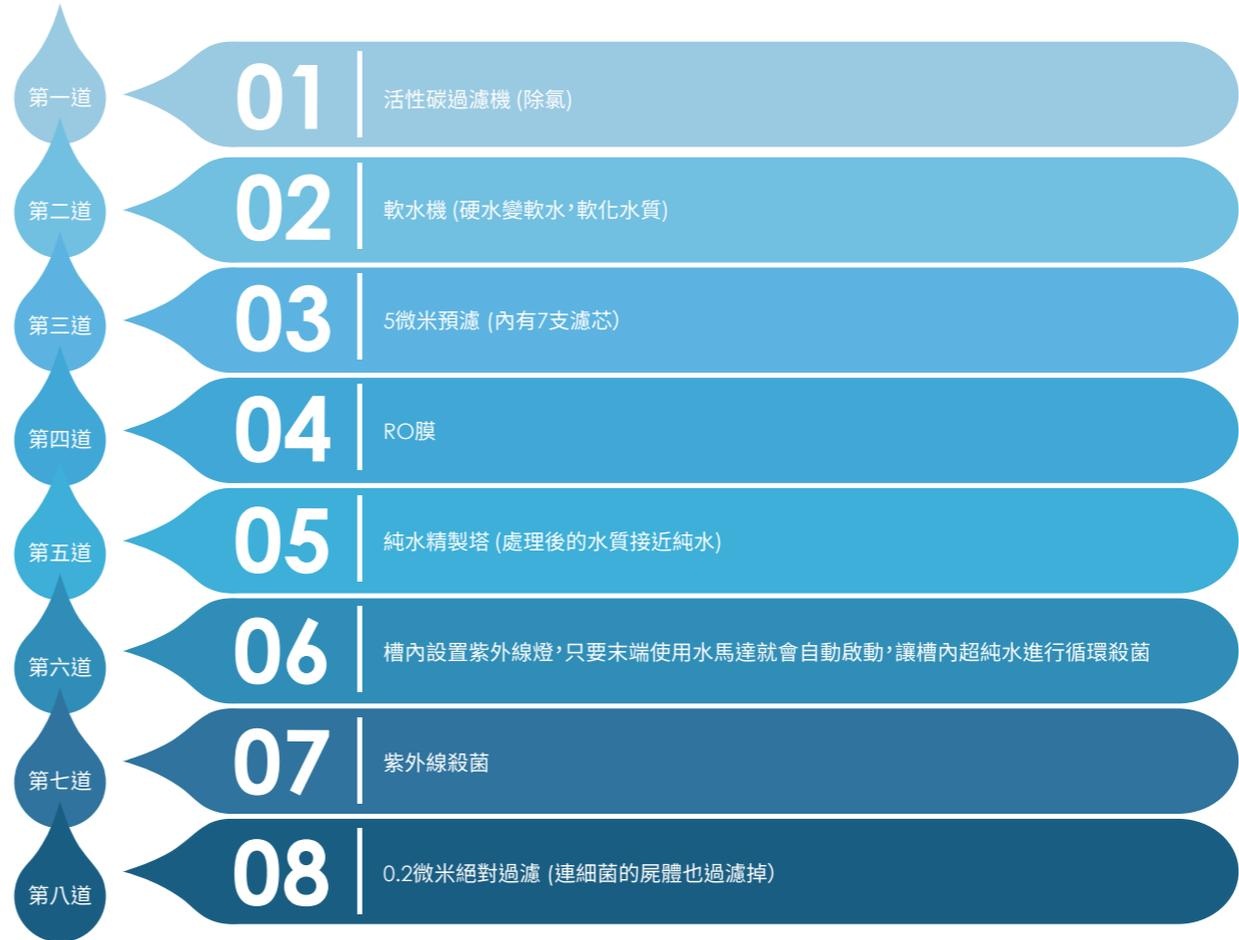
● 圖 2-14 八道程序製成超純水
